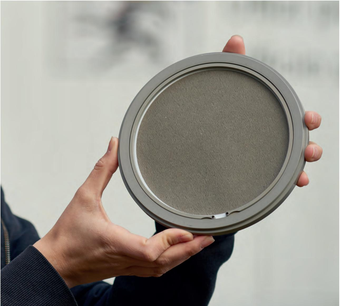
**Je nach PM10- und Russ-Belastung sind die Feinstaubfilter nach 24 Stunden Bestäubung unterschiedlich geschwärzt. Je dunkler die Filter, desto grösser ist die Belastung.
